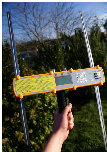
« L'atout majeur du radiogoniomètre LL16 est de permettre la combinaison de plusieurs modes de fonctionnement. On s'adapte avec efficacité aux conditions particulières de recherche et l'on évite notamment de se retrouver à l'opposé du lieu où se trouvent les survivants. C'est un équipement
